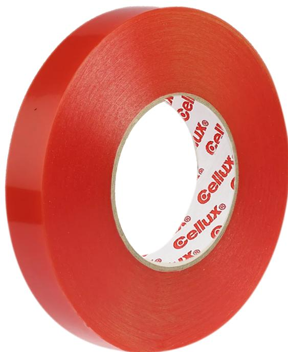
La cinta doble faz de poliéster (PET) Cellux® con adhesivo acrílico solvente de alto tack y Liner rojo de poliéster bisiliconado, está especialmente diseñada para el empalme y montaje de objetos de plástico, bobinas a nivel industrial como acero, aluminio, telas, vidrio y madera que están sometidos a altas temperaturas.
