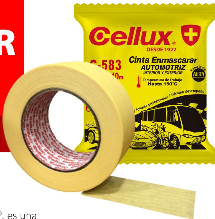
La cinta de enmascarar automotriz beige Cellux®, es una cinta compuesta por papel crepé HD + adhesivo de caucho reticulado especialmente diseñada para protección en procesos pintureros en la industria automotriz.
